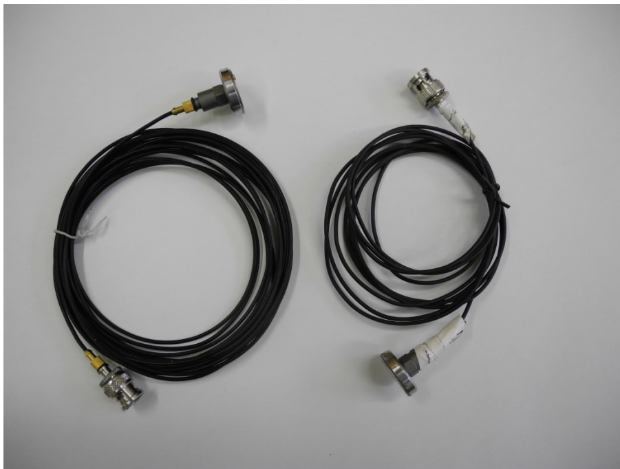
Obr. 3 Snímače zrychlení s magnety, kabely a konektory BNC
