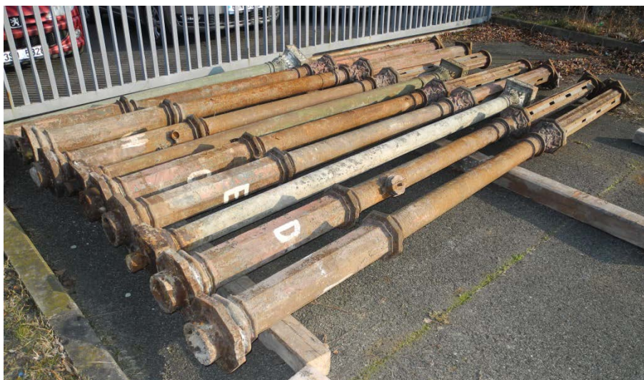
Obr. 10 Sloupy připravené ke zkoušce v areálu PRe
