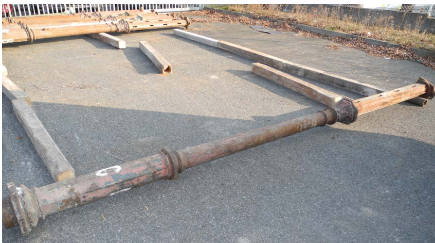
Obr. 11 Sloup připravený ke zkoušce. Vpravo podepřen ocelovým válcem.
