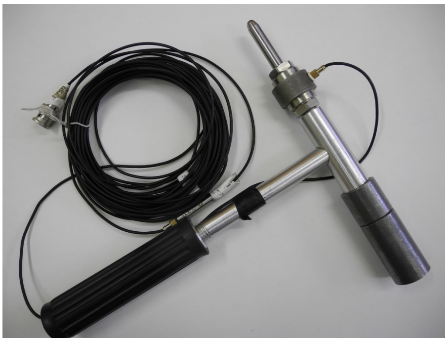
Obr. 4 Kladívko se snímačem síly, kabelem a zesilovačem IEPE
