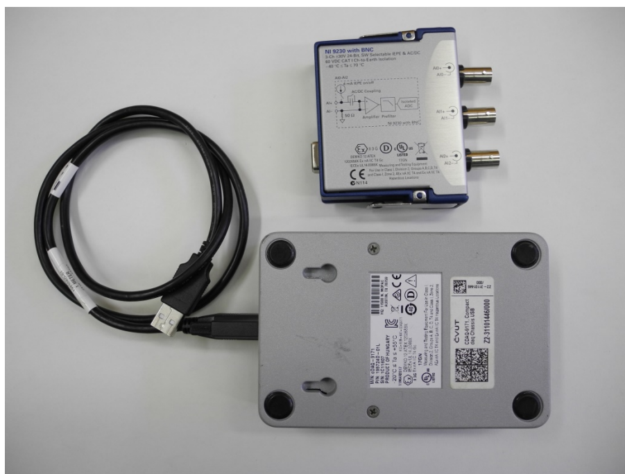
Obr. 5 USB jednotka a modul řady C (3x vstup IEPE) s převodníkem A/D
