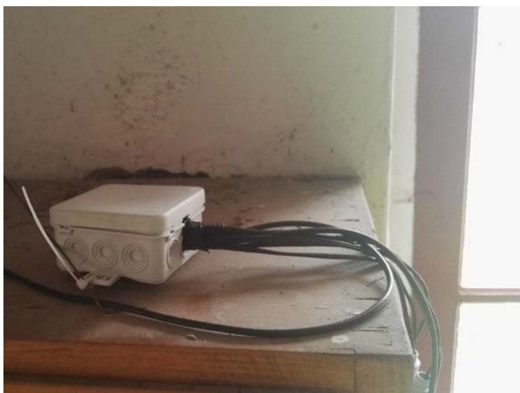
Obr. 17: Umístění měřicího zařízení v sakristii na skříni (měří 1 posun a 2 teploty)
