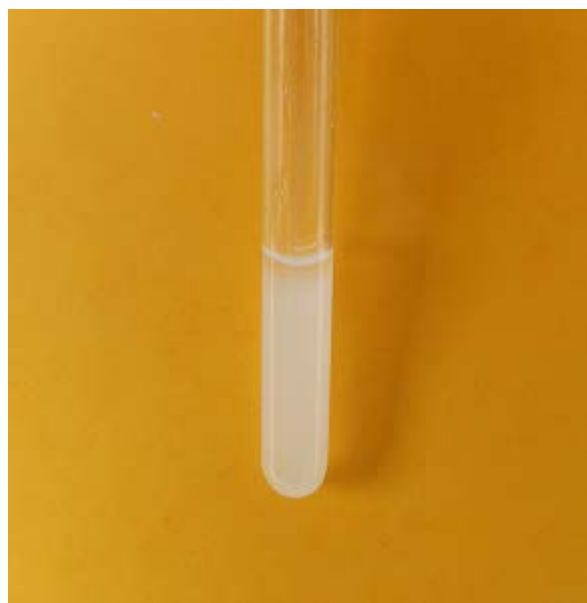
Obr. 12. Kolorimetrická detekce zvýšeného obsahu síranových aniontů ve zdivu a fragmentech omítky z odběrového místa 2A
