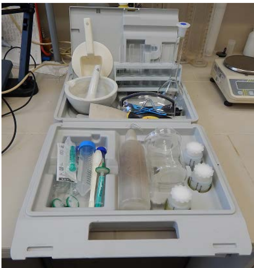
Obr. 4. Pohled na jednotlivé komponenty analytického setu pro in-situ stanovení obsahu solí v historickém zdivu a omítkách
