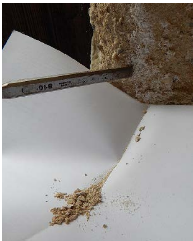
Obr. 5. Příklad odběru vzorku z fragmentu omítky a zdiva v rámci funkčního vzorku (obřadní síň Nového židovského hřbitova na Olšanech)
