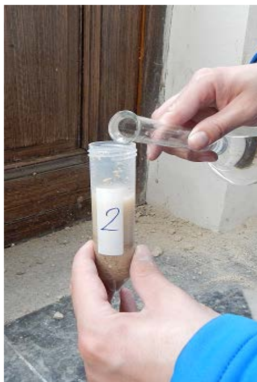
Obr. 6. Příklad rozpouštění vzorku z fragmentu omítky a zdiva v rámci funkčního vzorku (obřadní síň Nového židovského hřbitova na Olšanech)
