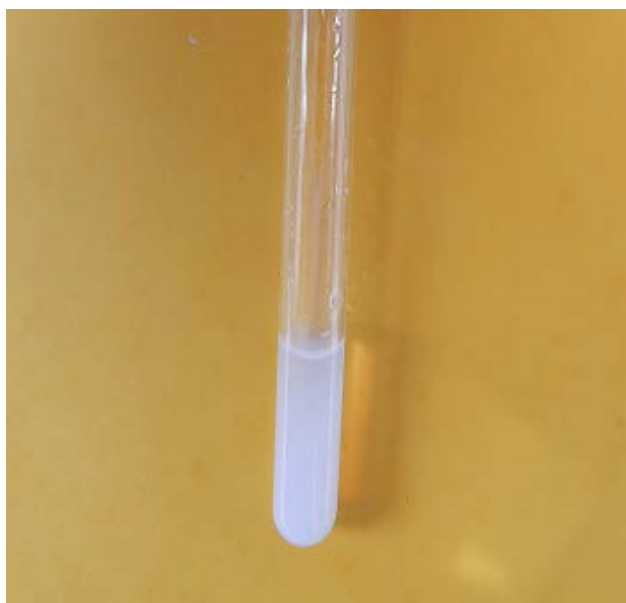
Obr. 11. Kolorimetrická detekce zvýšeného obsahu chloridových aniontů ve zdivu a fragmentech omítky z odběrového místa 1A
